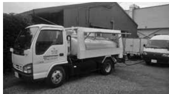
産廃汚泥の回収
