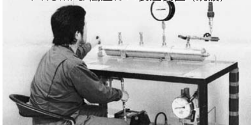
74.5MPa 高圧ガス製造装置（筑波）
